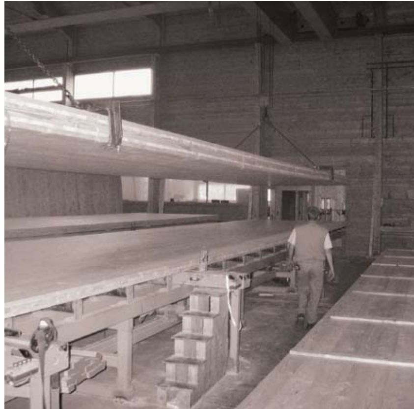
Produksjon av massivtreelementer. FOTO: NAL | ECOBOX.
